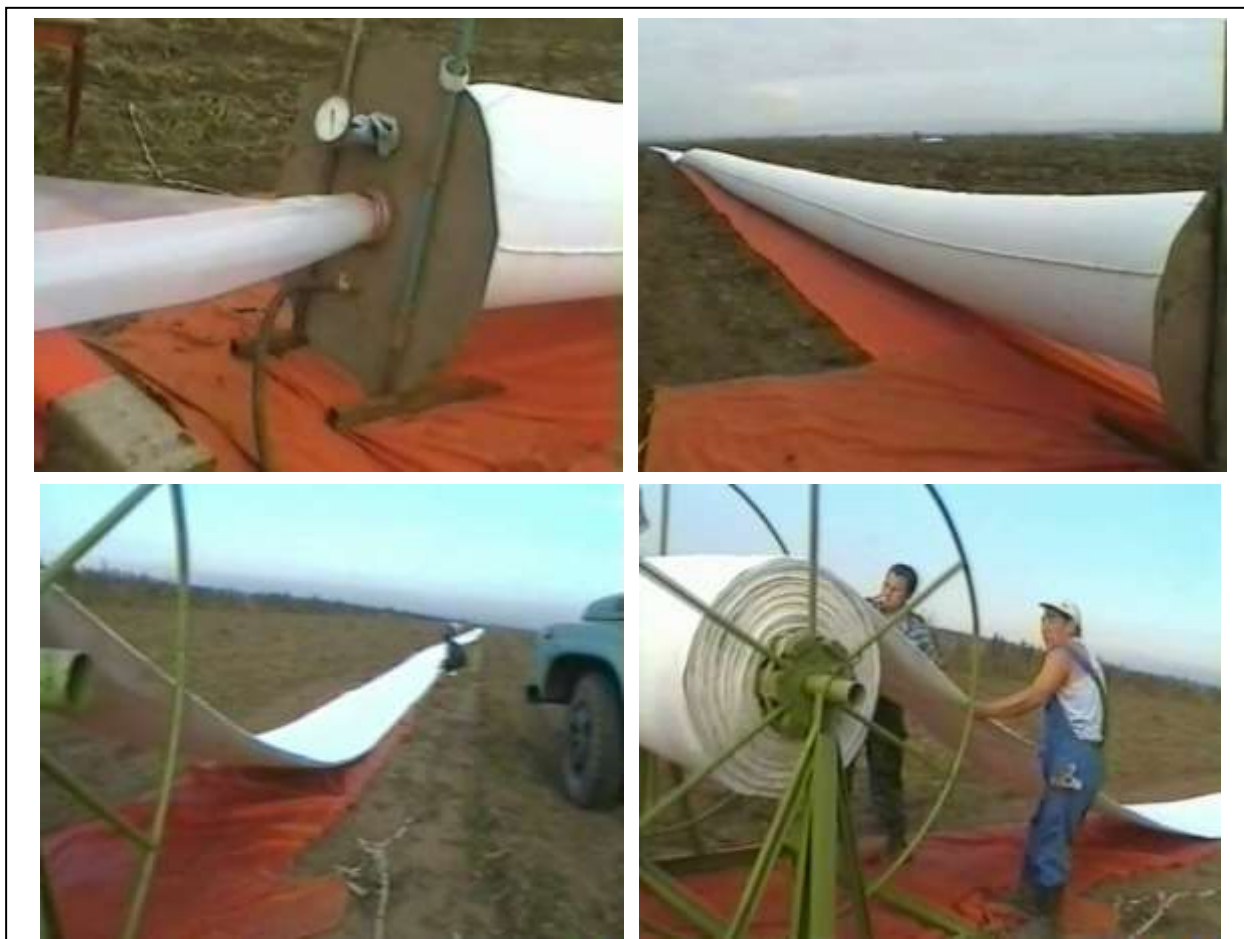
Рисунок 17. Фрагменты ввода полиэтиленового рукава внутрь тканевой оболочки путем выворота под давлением воздуха и намотка комбинированного рукава на барабан
