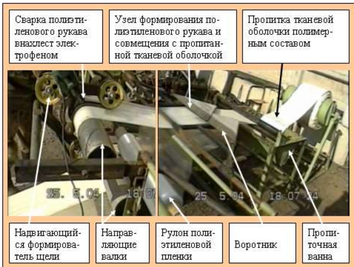
Рисунок 12. Устройство для изготовления комбинированного рукава
