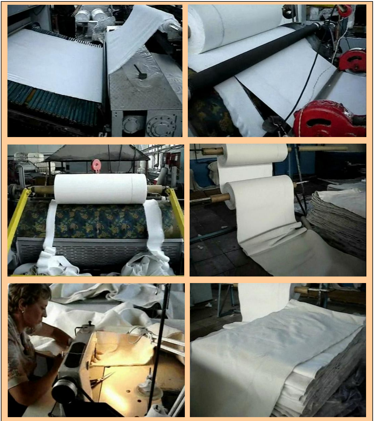
Рис. 4.1. Фрагменты изготовления рукавов на Иркутском заводе ОАО «Синтепон» для восстановления трубопровода Ду-700мм
