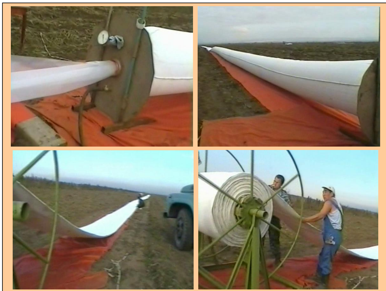
Рис. 4.18. Фрагменты ввода полиэтиленового рукава внутрь тканевой оболочки путем выворота под давлением воздуха и намотка комбинированного рукава на барабан
