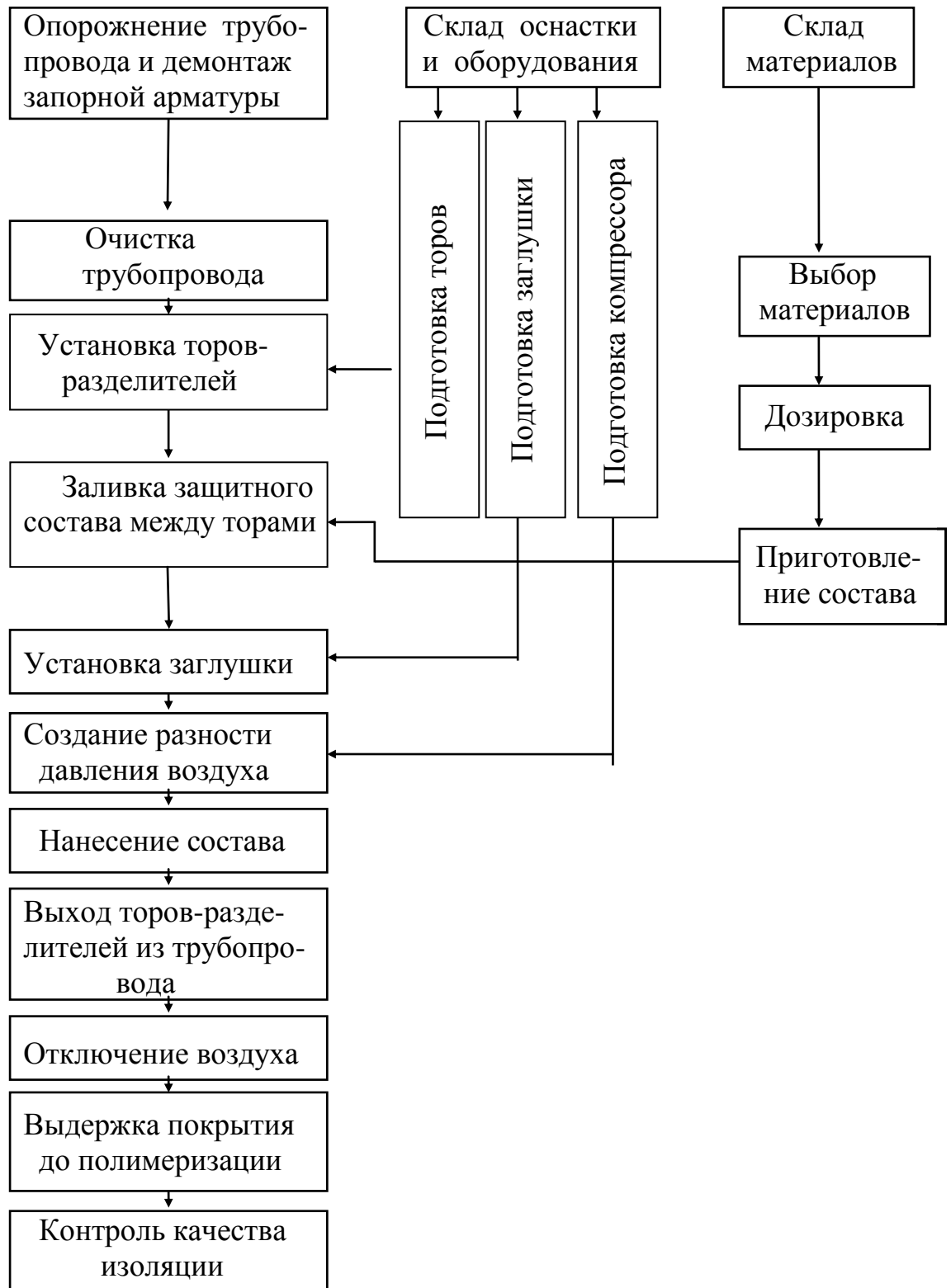
Рис. 3.26. Схема технологического процесса нанесения окрасочной изоляции на внутренней поверхности трубопровода в трассовых условиях
