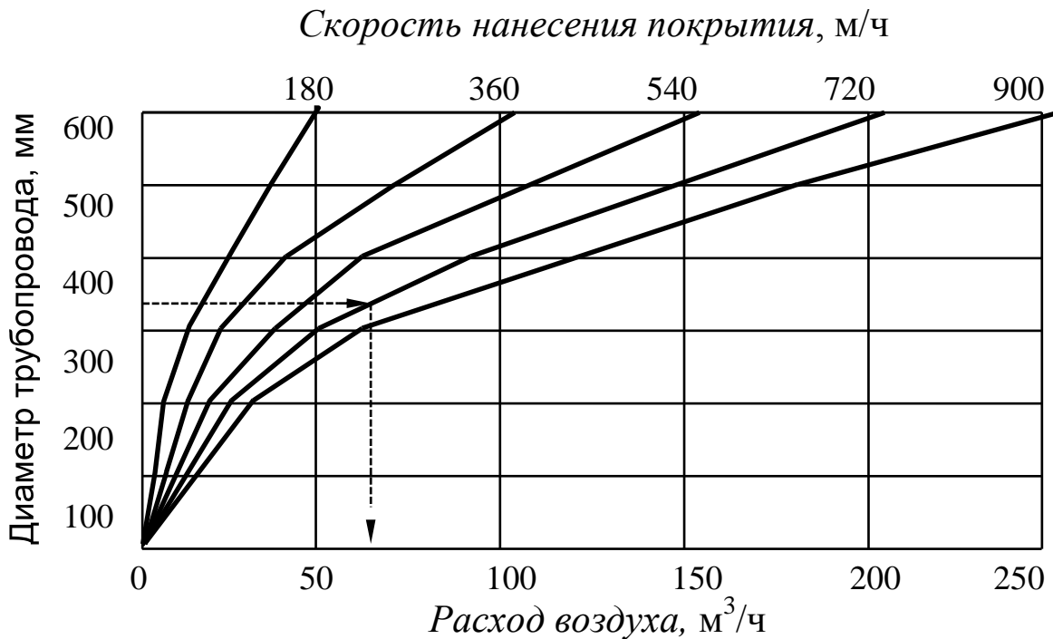
Рис. 3.19. Диаграмма по определению расхода воздуха для нанесения защитного состава с заданной скоростью
