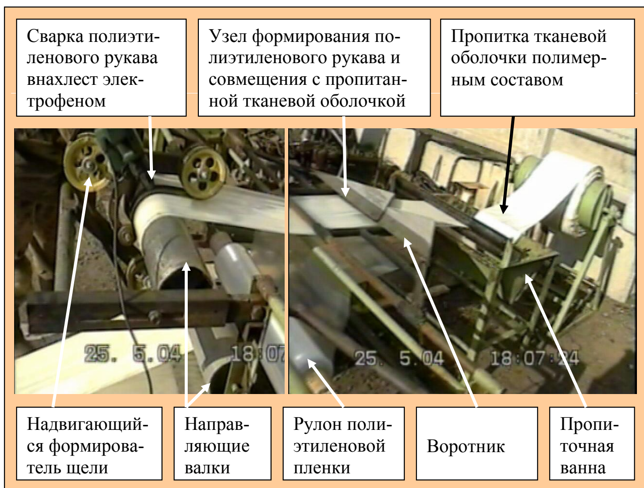
Рис. 4.17. Установка для изготовления полиэтиленовой оболочки и совмещения её с тканевым рукавом (тканевый рукав внутри полиэтиленового)
