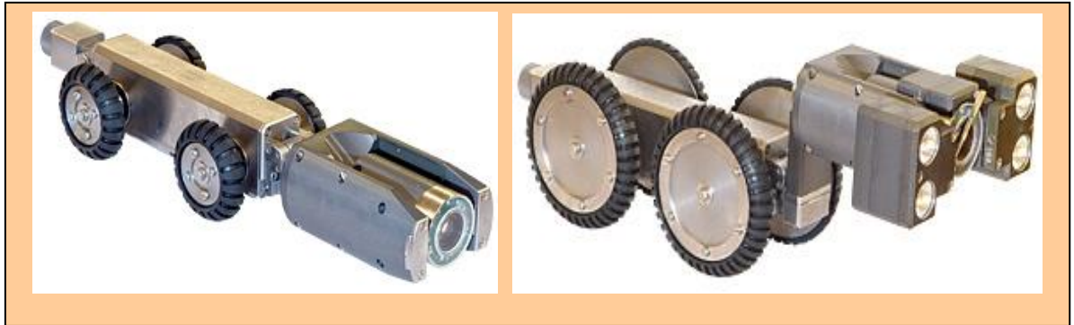
Рис. 4.19. Робот Р-100 ЗАО «ТАРИС» для телеинспекции трубопроводов
